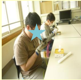
※漁業用ロープの先端をあぶって形を整えています
